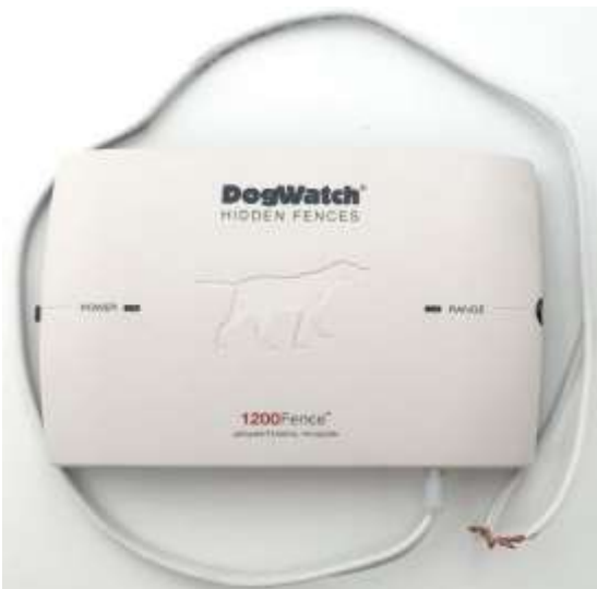
Figur 2 - Kortsluttet loop-wire på S1200
